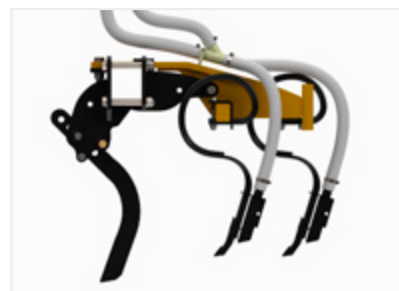
Compartimente de depozitare a îngrășământului pentru kitul de dinți dubli (plasare deasupra semințelor)
