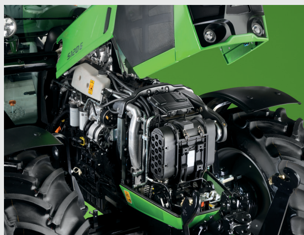
↑ Motor FARMotion cu sistem SCR pentru post-tratamentul gazelor de eșapament. Modelele cu clasă de emisii III B nu au nevoie de AdBlue.
