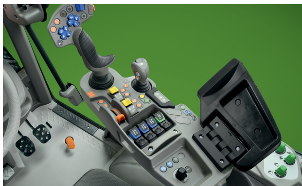
↑ Consolă MaxCom cu manșă ergonomică și funcții codate clar pe culori.
