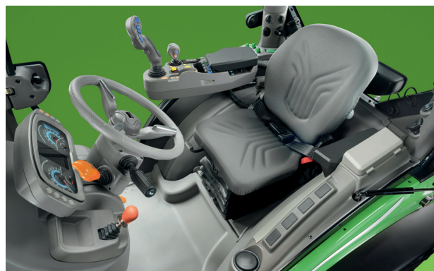
↑ Cabină spațioasă cu 4 stâlpi, cu podea complet plată, mulțumită transmisiei TTV compacte dispuse la joasă înălțime.
